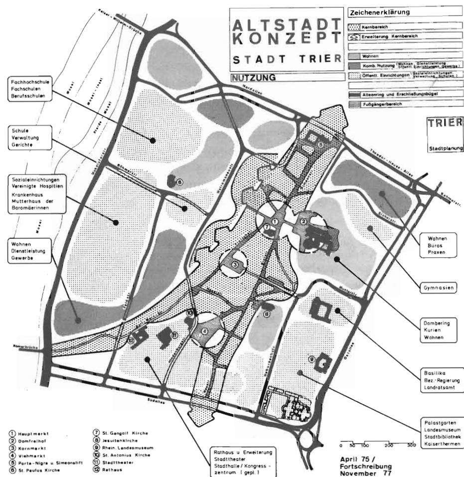
Abb. 3 Altstadt-Konzept: Nutzung. Nutzungsgliederung der Altstadt mit ihrer charakteristischen Dreiteilung und mit der Vielfalt der zentralörtlichen Funktionen. Alleengeviert mit inneren Haupterschließungsstraßen.
