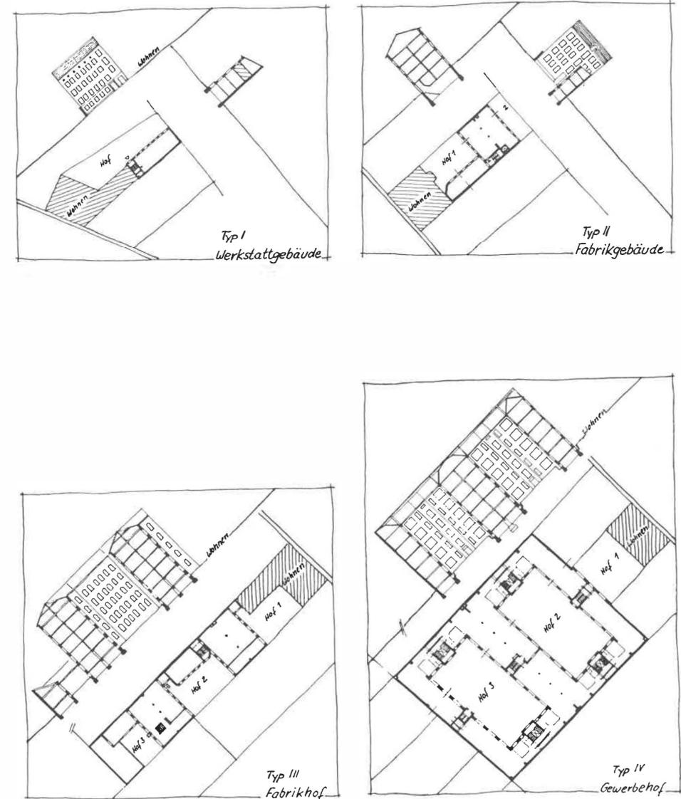
Abb. 1 Schematische Darstellung der Gewerbegebäudetypen
